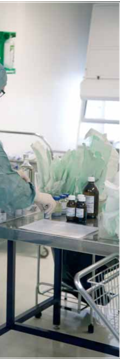
Beredning av testning av sterila preparat i utrymmen av renlighetsklass B, en del av kvalitetssäkringen enligt GMP-normen.
