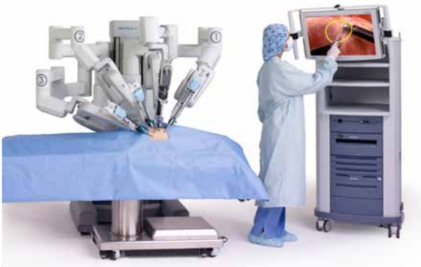
Kuvassa leikkausrobotin leikkausyksikkö ja valvontamonitori. Laitteeseen liittyy myös konsoli, josta leikkaava kirurgi käyttää laitetta. ©2010 Intuitive Surgical, Inc.)
